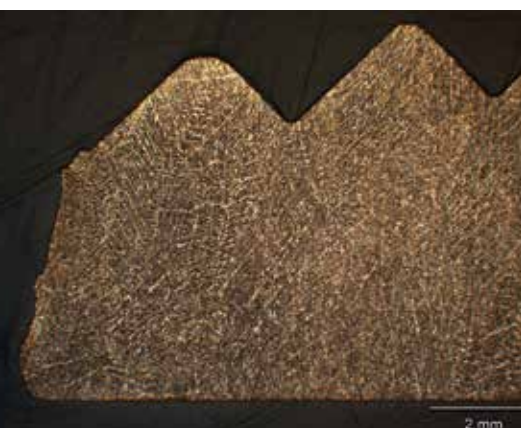
Eine Makroaufnahme vom Schlüssel des Herstellers TTT, der gebrochen ist.
