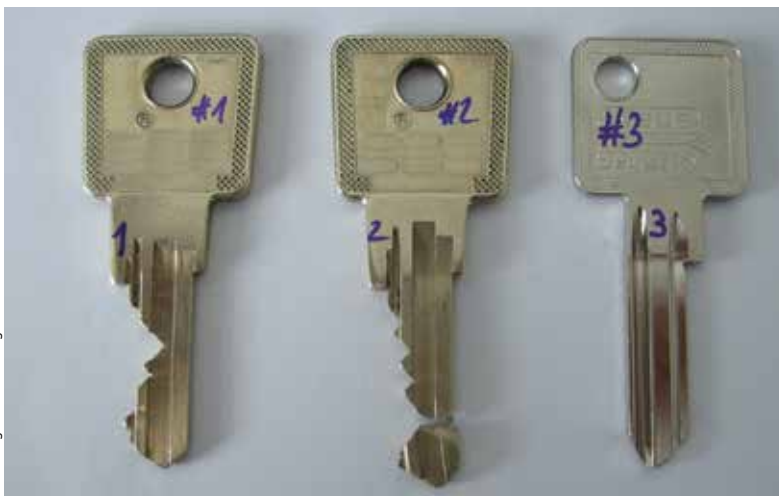
Der linke Schlüssel ist intakt, hat aber einen Riss in den Schließzähnen, der Schlüssel in der Mitte ist gebrochen; rechts ist ein Vergleichsschlüssel zu sehen.
